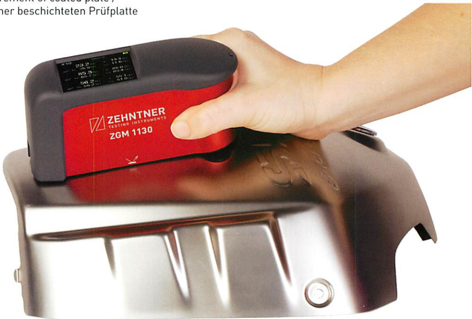
Gloss measurements on metals / Glanzmessung auf Metallen
