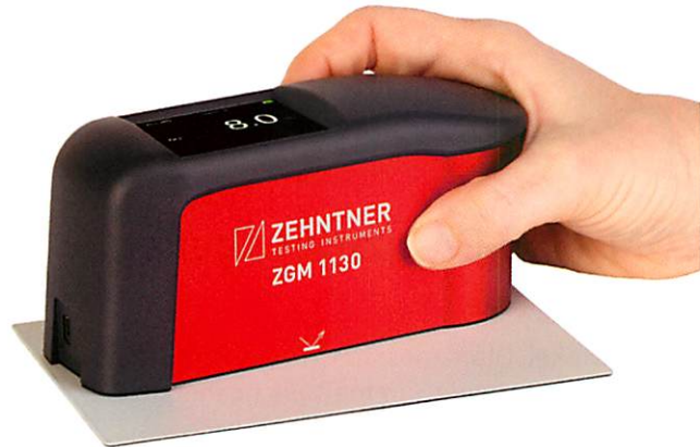
Gloss measurement of coated plate / Glanzmessung einer beschichteten Prüfplatte
