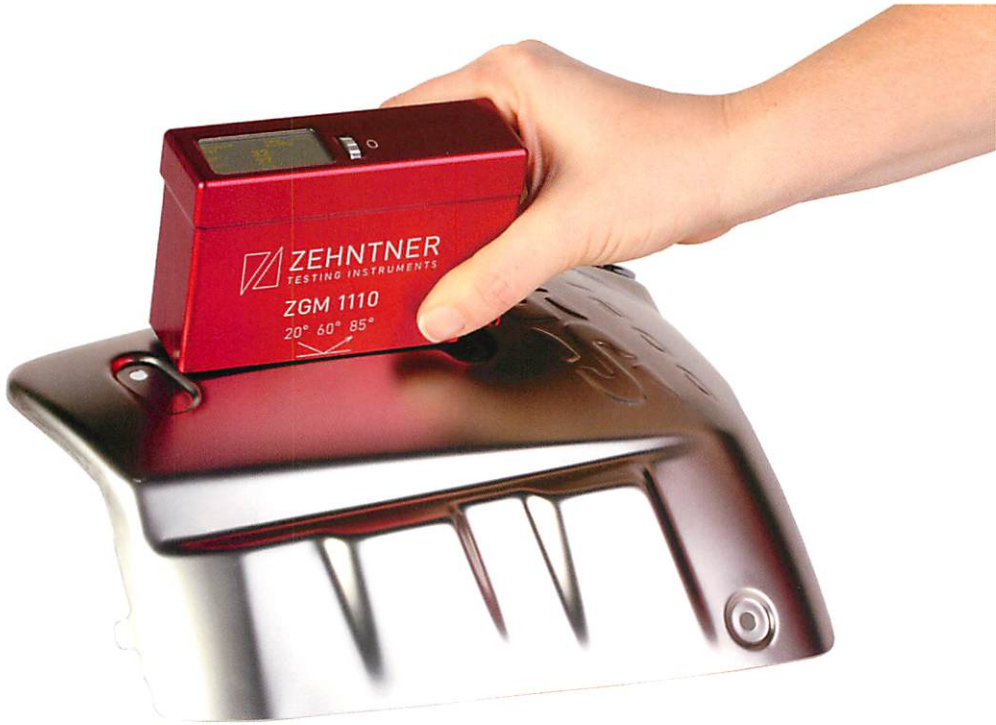
Gloss measurements on metals / Glanzmessung auf Metallen
