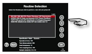
この装置は、あらかじめ設定されているインストラクションにより、サンプルが 国際基準に適合した試験を実施できることを保証します。
