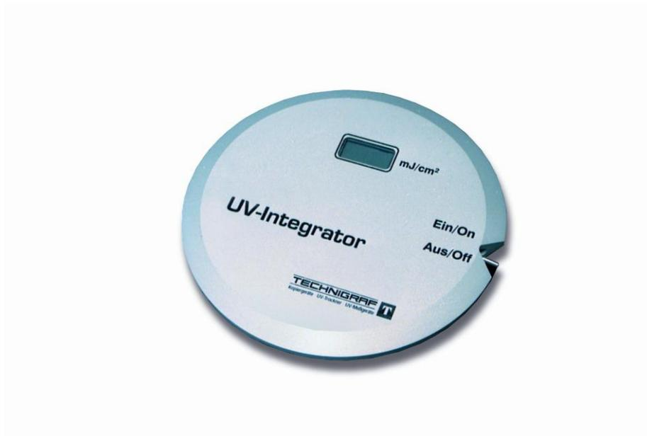
UV インテグレーターは、UV 放射線スペクトル全体の相対的なディスプレイを備えた計測器です。この計測器は、慣例的に UV をチェックするために UV ドライヤーを通過させることに適しています。さらに、完全に UV コーティングを直し、かつ必要なコンベヤーベルト速度を決定するために必要な UV 放射線量を決定するのをサポートするために、重要なツールとして役立ちます。高い測定精度を持っており操作が簡単です。
