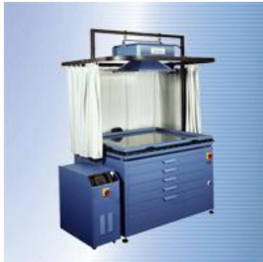
この装置は、スクリーン・コピー・フレーム、スクリーン乾燥キャビネット(5つのラックを備えた)、省エネルギー、軽い積分器、耐UV性の光保護カーテンおよび個別のモバイルのコントロール・パネルから構成されています。
