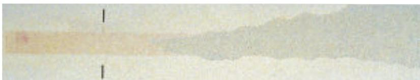
プリンティングディスクが印刷後に紙から離反するとき、インキのタックや粘度の影響によって紙負荷がかかります。インキタック値・粘度・印刷速度が大きくなるに従ってこの力も大きくなります。そしてこの力が一定値を超えると、紙の表面にダメージを与えます。また、このテストでは、紙のデラミネーションを評価試験することもできます。W31,38,65,75,86,87,88
