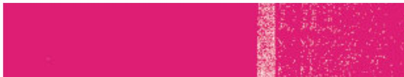
ことがあります。特に印刷工程では、紙が濡れている場所で水がインキ転移に影響してしまうかもしれません。それは、紙の表面構造を変えてしまうからです。例えば、水は、紙粉・異物がインキのタックによって紙の表面から剥がれる現象を増長させ、紙の表面を弱らせてしまうことがあります。この現象を、ウェットピックと言います。水による別な影響として、水の被膜が紙の表面に残ることによってインキが転移されないことがあります。この現象をウェットリペレンスと言います。W32,66 4, 7
