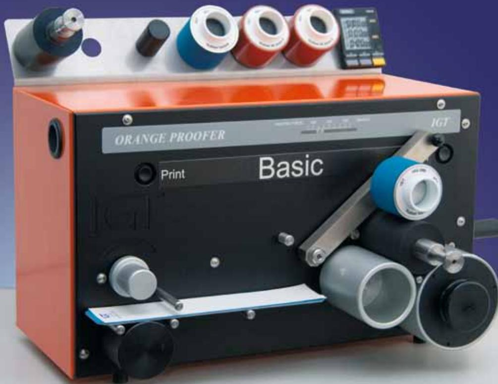
カラーマッチングシステムと併用されるIGT試験機には、オレンジブルーファとC1があります。オレンジブルーファは、コストパフォーマンスが高く、簡単な操作で試験を実施できます。一方のC1は、7日間で
