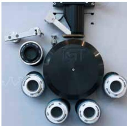
ーテストでは、2つの測定ポイントを紙ストリップ上に設定し、加湿します。その後、もう一度この2つの距離を慎重に測定し、距離の伸びを測ります。水の量と加湿時間を設定します。なぜなら試験結果に大きな影響を及ぼすからです。専用ソフトは、カメラ画像などから試験結果を分析します。
