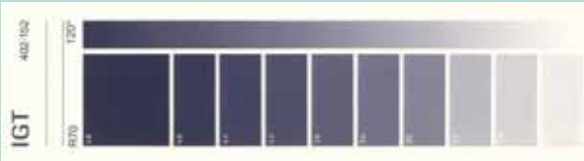
10区間でカラー測定するため、及び、基材 (試験片) の平滑度を測定するためのグラビア印刷
