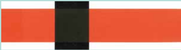
カバレッジ、透明性、カラー、濃度等の測定のための、黒色帯付リファレンス紙へのフレキシ印刷。
