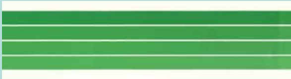
4つのインキ層でカラー測定するための、4カ所の帯状フレキシ印刷
