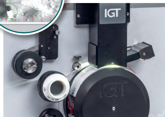
IGT Pick ISO 3783: 「Low lamp」の付いたカメラがスキャンしています
