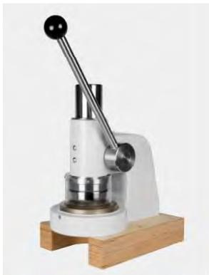
円形ブレードを手動レバーで打ち抜き型に押し込むと、サンプルは下方に押される
