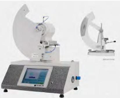
各種素材の引裂き強さ測定
