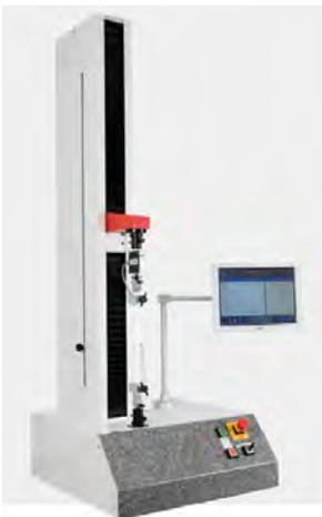
各種引張試験と圧力試験が可能な試験機
