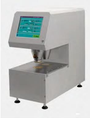
使い易いタッチスクリーンと Frank-PTI 接続を標準装備し、各種素材の引裂き強さを測定
