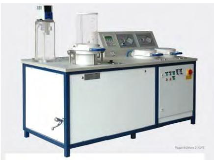
直径 200mm 標準シートの作成と懸濁液からの薬品による循環型白水の濃縮
