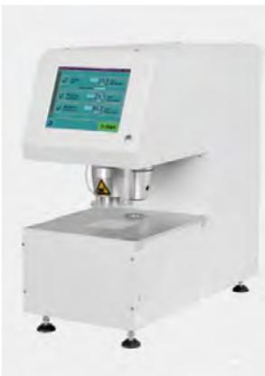
表面平滑度と透気度を測定
