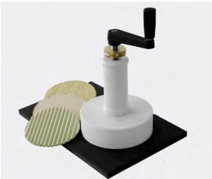
クラッシュテスターの FCT 試験用に特別に開発したもので、正確に表面積 100cm<sup>2</sup>のサンプルを作成する
