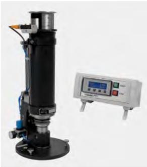
ガーレ方式により透気度を測定
