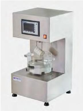
ティッシュの水分吸収時間及び吸水性の測定
