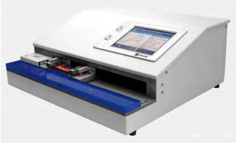
乾燥及びびウエット状態の紙、板紙、ティシューの引張強度、引張伸び、引張剛度、裂断長、引張エネルギー吸収を測定する
