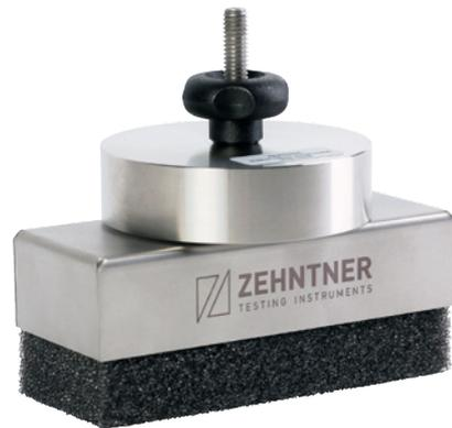
摩耗セット ASTM D4828
