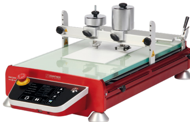
ACC1285修正セット「クロックメーター」、および2つの摩擦フィンガーセットと対応するウェイトを装備したZAA 2600
