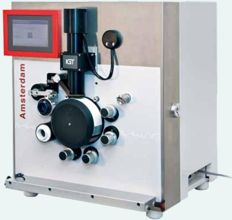
IGTは次の3種類の多目的印刷適性試験機を製造販売しています：AMSTERDAM、グローバルスタンダード・テスター、AIC2-5 T2000シリーズ。これらの試験機は、様々な種類の紙、ボール紙などの試験片を用いて、オフセット、グラビア、フレキソインキで試験することができます。モデルは、定速、加速及びその両方での測定が可能です。必要とされる特定の試験に合うインキ練り装置など各種付属品が用意されています。
