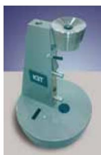
に設計されています。ラレーは、ロッドに加えられる重量（負荷）によって、測定材の薄膜がロッドとカラー（シリンダー）間で分離される際の落下速度を測定します。この落下速度は、測定材料の粘度によって変化します。落下時間は異なる錘で調整できます。この装置は、100mmの距離間の2ポイントのロッド落下速度を測定します。ロッドおよびカラー（シリンダー）は、恒温水槽によって温度管理されます。この装置には、50/100/200/500gの錘が標準装備されており、100-1000gの間で50g単位でオプションを用意しています。IGTラレービスコメーターはPCデータ転送と粘度計算ソフトウェアが付属されています。
