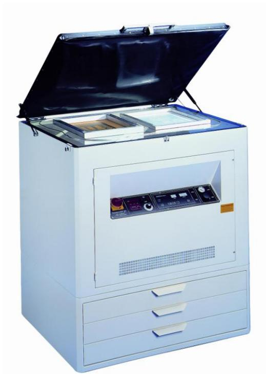
3つの乾燥ラックを備えたこの専門のスクリーン・コピー・ユニットは、大きなフォーマット・スクリーン・フレームに小さなUV感光乳剤およびフィルムを照射し乾燥することを目的として製造しました。省エネ仕様のAKTICOP S MH-INSTANT COPY LAMPは、完全真空排気および接触シーケンスに加えて、小型のモデルが提示するベースプレートに装着されます。4つの角のあるスクリーンを備えた3つのサーモスタットで乾燥ラックが調整可能です。
