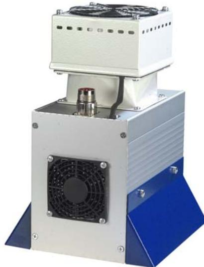
この装置は、軽量・空冷式で単一のランプ(Hg(最大 160W/cm))です。インクジェットの工程や、粘着性およびUVインキおよび他のコーティングカラーを迅速に照射するのに適しています。電子安定器を備えたこの高機能モジュールは、既存のインクジェット印刷機および他の既存の生産ラインへ簡単に統合することができます。このインクジェットのモジュールは安定したアルミニウム・プロフィールハウジングを持っており、頑丈なアルミニウム半殻反射器、ランプハウジング、制御入力および出力信号上のアルミニウム冷却ファン、アルミニウム水晶板、振動なしの空気の反射器シャッタおよびECG(電子安定器)を装備しています。電子安定器は有効に線間電圧変動を補います。また、UVランプ出力は、30から100%まで連続的に調整可能です。
