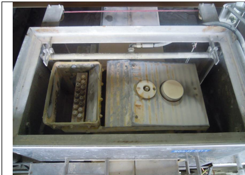
水分および透過性測定センサーを備えたクリーニングヘッド
