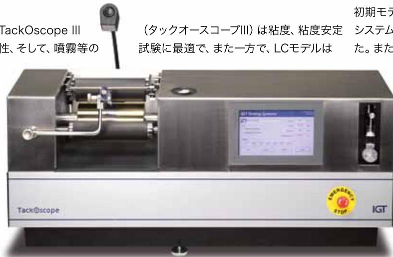
湿し水や添加剤と結合したインキの特性を再現します。TackOscope III (タックオースコープIII) LCのカメラは、どのように、また乳化したインキのプレートクリーニング物性にどのくらい湿し水が影響を与えるかを詳しく立証するために使われます。
