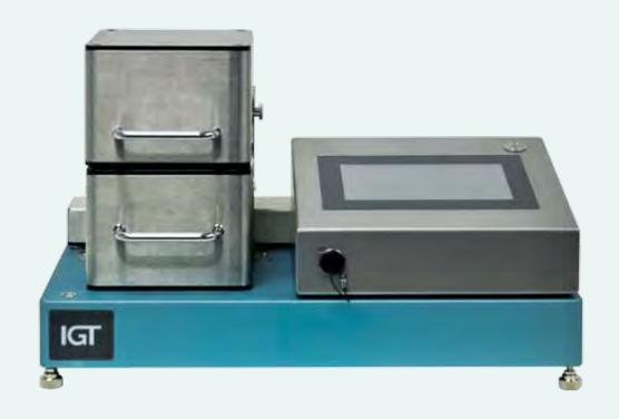
IGT SizeOscopeは、反射率の変化による紙・板紙のサイジングを自動評価するための装置です。 これは、あらゆる種類の水液体で使用できるように設計されており、液体と接触する材料は、製紙業界で一般的なすべての液体に適しています。
